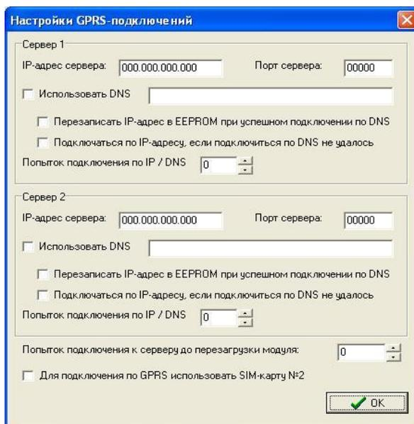
Рисунок Г29 – Отметка для подключения прибора по каналу GPRS
