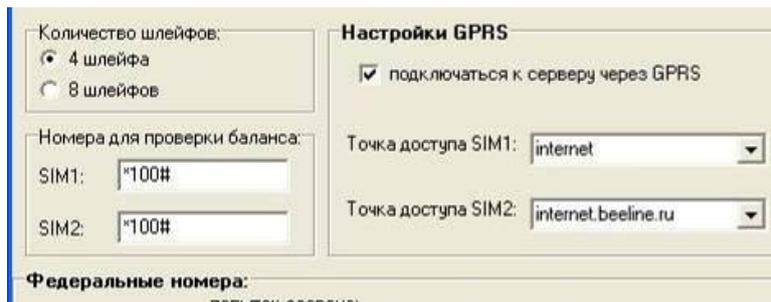
Рисунок Г28 – Отметка для подключения прибора по каналу GPRS
