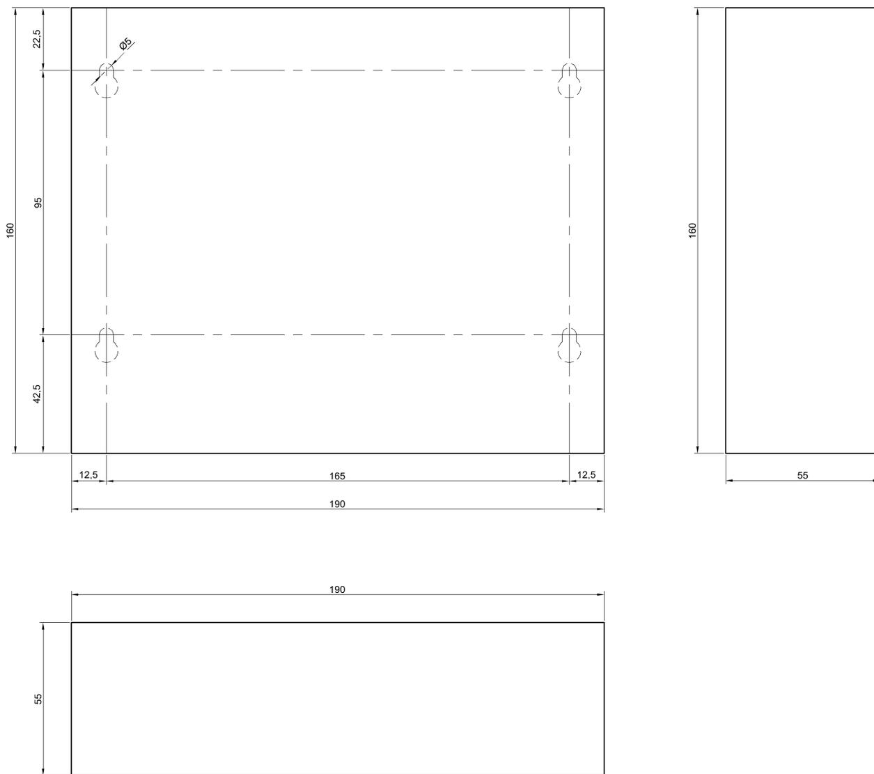
Рисунок А3 – Габаритные и установочные размеры прибора
