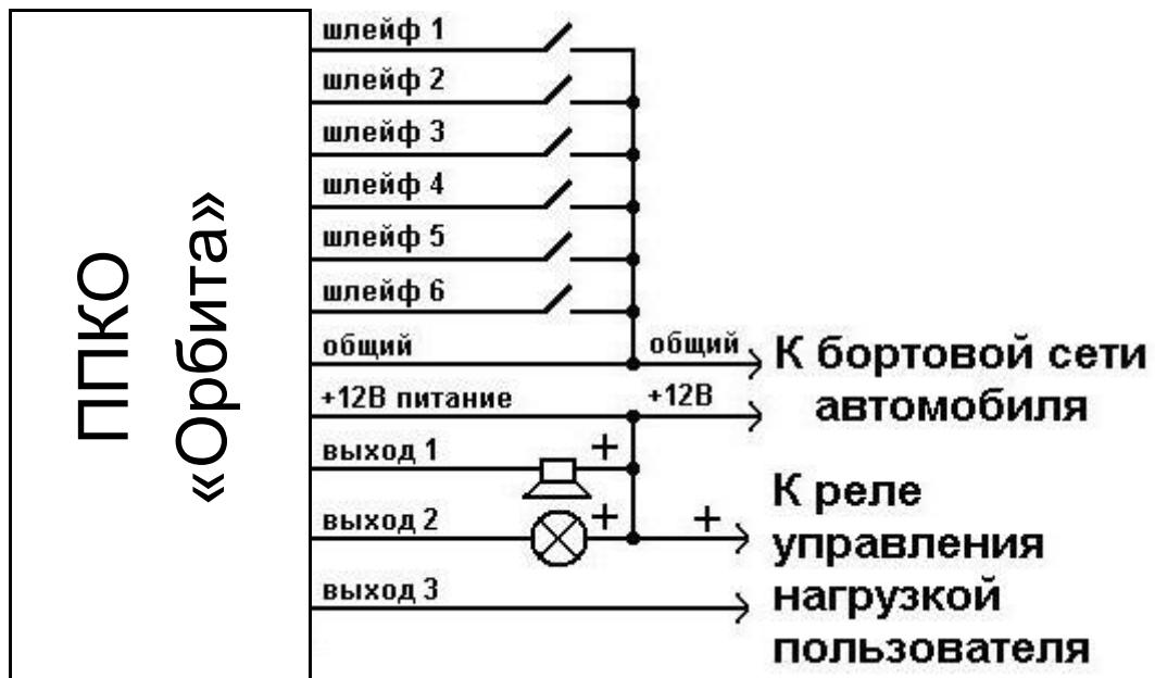
Рисунок Б.1 – Вариант схемы внешних соединений прибора
